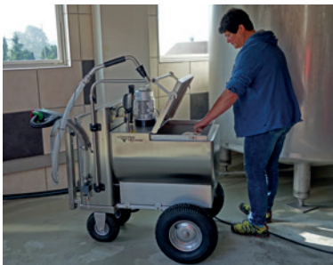
Liegender Tank mit Wasserbad
