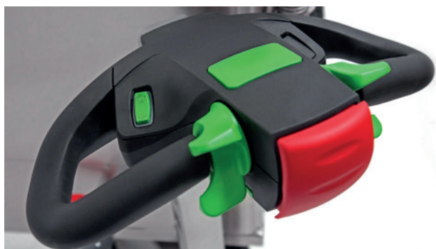
Deichselkopf mit integrierten Funktionstasten
